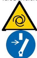
Bei Arbeiten an kraftbetriebenen Anlagen ist dafür zu sorgen, dass diese Anlagen nicht selbsttätig anlaufen können. Unterlassen Sie das Warten von Maschinen und Aggregaten, solange diese sich noch bewegen. Ferngesteuerte Anlagen sind zunächst auf „örtlich“ zu schalten. Vorhandene **Reparaturschalter** müssen benutzt werden.
